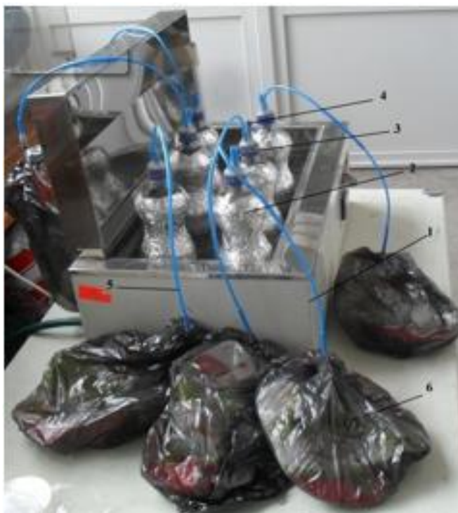
Figura 53. Stand de testare la scară redusă: 1 – baie termostată, 2 – PET cu un volum total de 2 L, 3 – dopurile sticlelor de plastic, 4 – orificiul furtunului pentru introducerea seringii, 5 – record, 6 – recipient pentru depozitarea biogazului
