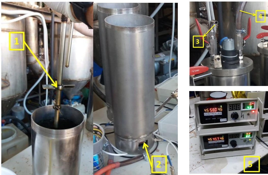
Figura 55. Prezentarea general a instalației de laborator: 1-agitator cu două lame; 2- sursa de încălzire; 3 – ieșire de biogaz; 4 - ieșire eșantion; 5 – afișaj pentru controlul temperaturii și al amestecării
